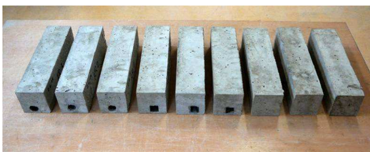
Obr. 5.: Zkušební tělesa: vlevo sada s vloženou kruhovou trubkou, uprostřed sada se čtvercovou trubkou, vpravo referenční hranoly.
