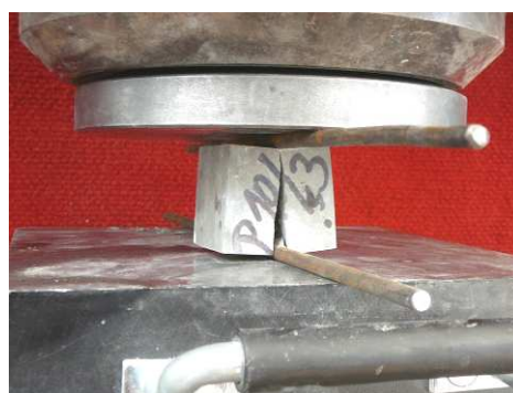
Obr. 8.: Způsob porušení zkušebního tělesa masivního čtvercového průřezu v příčném tahu.
