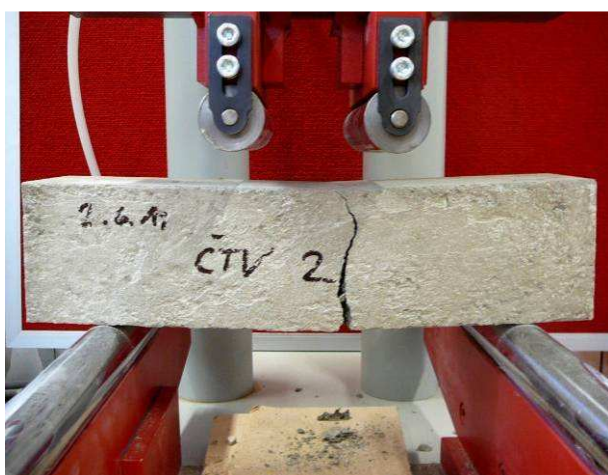
Obr. 9.: Hranol s vloženou čtvercovou trubicí po zkoušce pevnosti v tahu ohybem - extrudovaná trubka s betonem nespolečnil.
