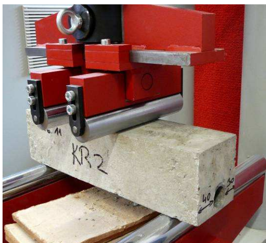
Obr. 7.: Zkouška hranolu s vloženou kruhovou trubicí.
