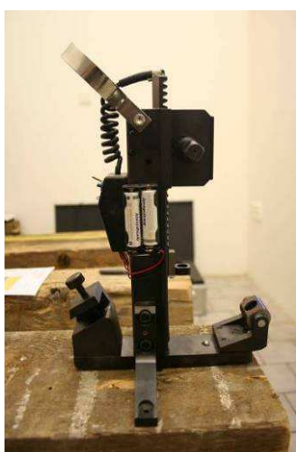
Obr. 7.: Boční pohled na přístroj pro „in-situ“ měření mechanického odporu dřeva při zatlačování trnu.
