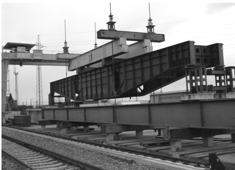
Obr. 3.: Uspořádání zkušebního zařízení – zkušební sestava: pohled z boku
