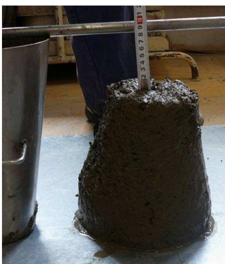
Obr. 1.: Zjišťování sednutí kužele betonu.
