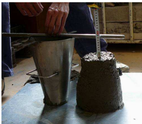
Obr. 3.: Zjišťování sednutí kužele použitého betonu.
