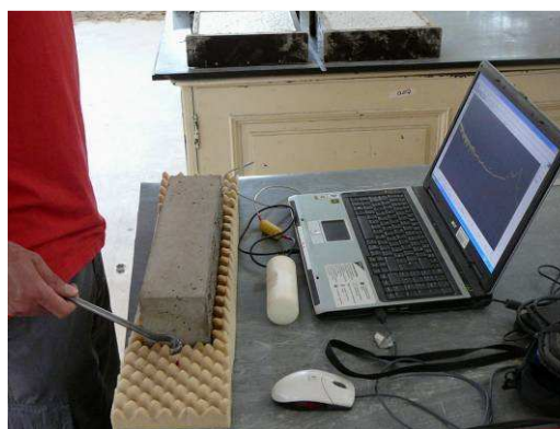
Obr. 9.: Měření modulu pružnosti rezonanční metodou.
