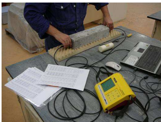
Obr. 3.: Měření dynamického modulu pružnosti ultrazukovou metodou.
