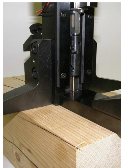
Obr. 10.: Univerzální přístroj pro zatlačování trnu a vytahování vrutu
