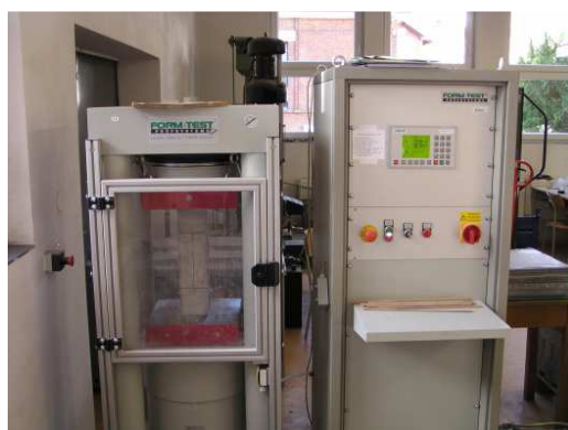
Obr. 6.: Stanovení hranolové pevnosti v tlaku v lisu FORM+TEST.
