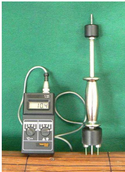
Obr. 1.: Příklad na měření vlhkost dřeva Hygrotest 6500 se zářezací sondou.
