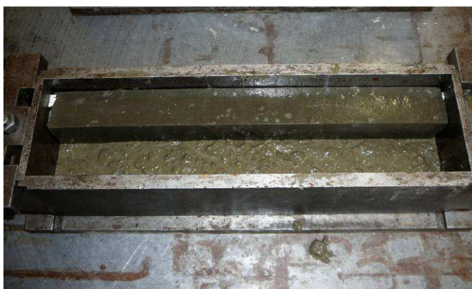
Obr. 3.: Vložení čtvercové trubky do formy na zhutněnou vrstvu betonu.
