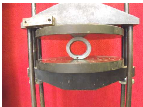
Obr. 5.: Zatěžování zkušebního tělesa s uzavřeným tenkostěnným kruhovým průřezem v tlaku.
