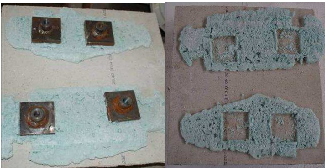
Obr. 2.: Přilepení odtrhových terčů a vzorek po provedení odtrhu.
