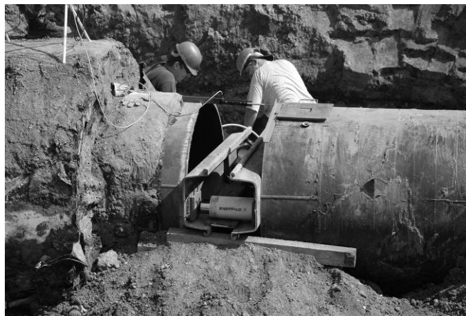
Obr. 7 Realizácia simulácie pozdĺžneho zosuvu
