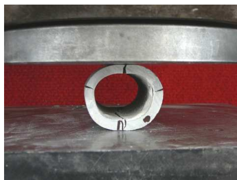
Obr. 6.: Způsob porušení zkušebního tělesa s uzavřeným tenkostěnným kruhovým průřezem v tlaku.
