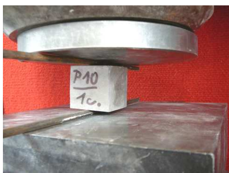
Obr. 7.: Zatěžování zkušebního tělesa masivního čtvercového průřezu v příčném tahu.
