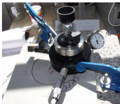
Obr. 3.: Měření přístrojem GWT
