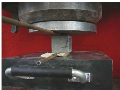
Obr. 3.: Zatěžování zkušebního tělesa s uzavřeným tenkostěnným čtvercovým průřezem v tahu.
