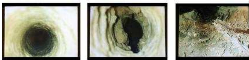
Obr. 15.: Obraz získaný pomocí přístroje Videoprobe XL PRO z jednotlivých vrtaných sond.
