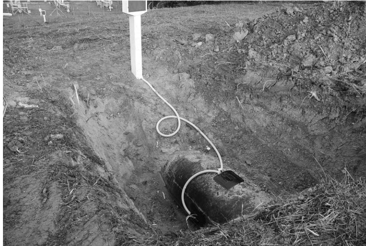
Obr. 7.: Snímače s vyvedenou kabelážou do meracieho stĺpika
