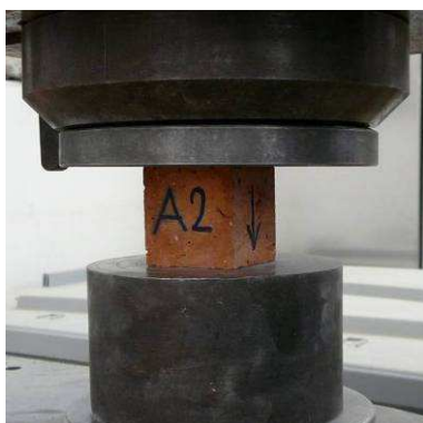
Obr. 8.: Vzorek před zkouškou pevnosti v tlaku
