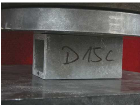
Obr. 1.: Zatěžování zkušebního tělesa s uzavřeným tenkostěnným čtvercovým průřezem v tlaku.
