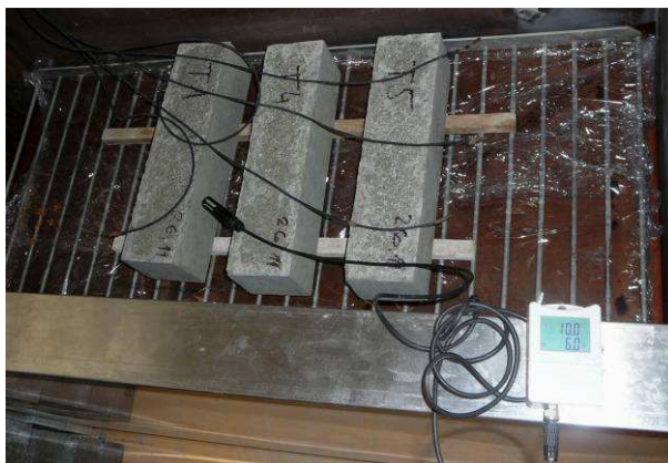
Obr. 6.: Po odformování byla do chladných podmínek vrácena pouze zkušební tělesa první sady.
