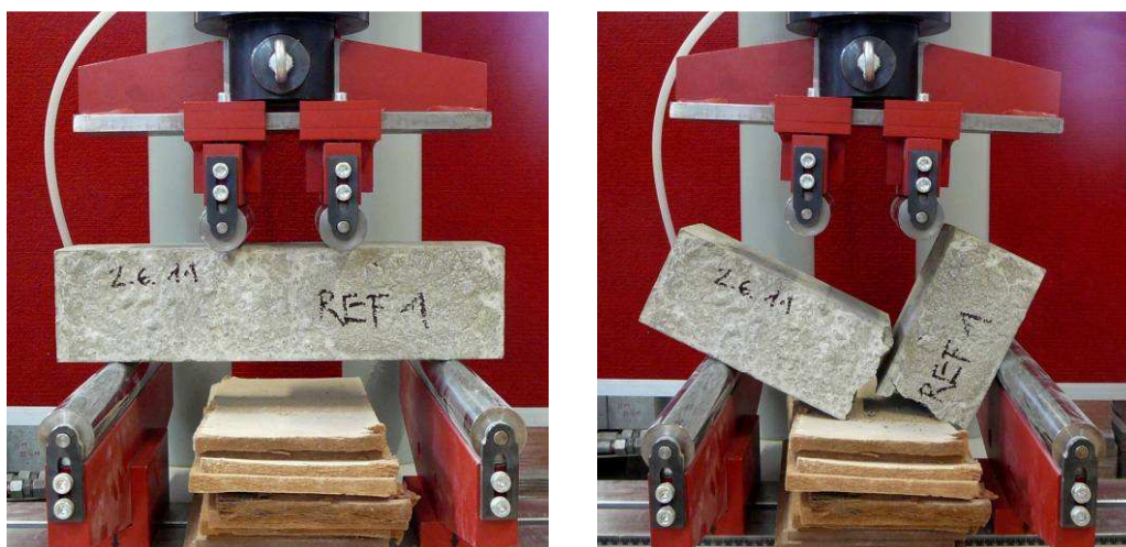
Obr. 6.: Zkouška pevnosti v tahu ohybem referenčního hranolu.
