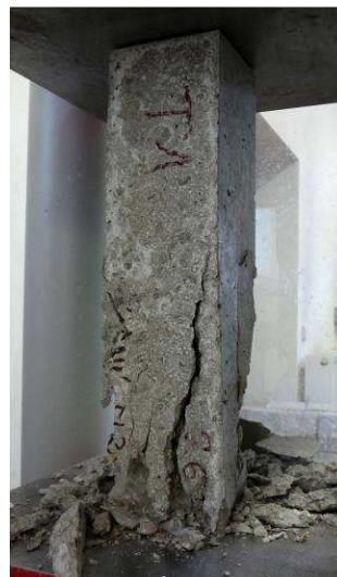
Obr. 11.: Stanovení pevnosti betonu v tlaku – hranol po zkoušce.
