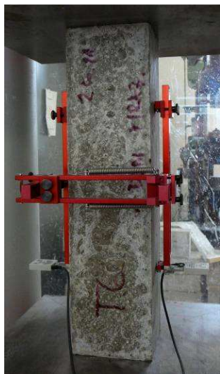
Obr. 10.: Měření statického modulu pružnosti v lisu FORM+TEST.
