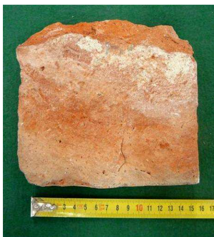
Obr. 6.: Část cihly B, která byla po odzkoušení tvrdoměrem odebrána z klenby
