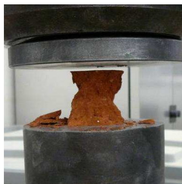
Obr. 9.: Vzorek po zkoušce pevnosti v tlaku
