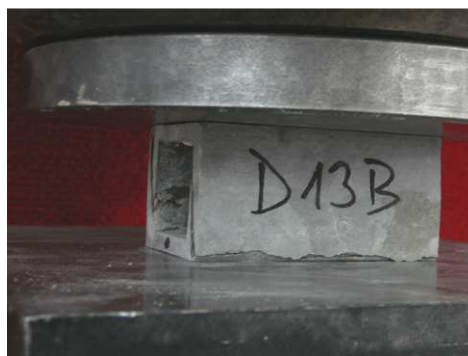
Obr. 2.: Způsob porušení zkušebního tělesa s uzavřeným tenkostěnným čtvercovým průřezem v tlaku.
