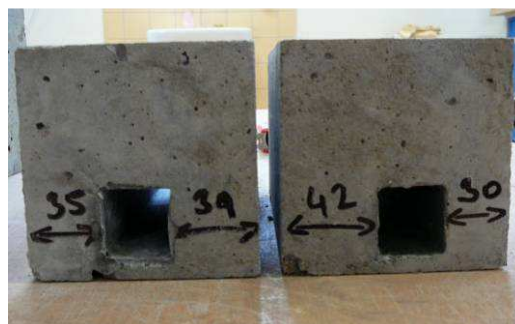
Obr. 8.: Umístění čtvercové trubky v hranolu – snaha o uložení na střed zkoušeného tělesa byla téměř úspěšná, odchylky způsobené „vyplaváním“ trubky při vibraci neměly na výsledky zkoušek vliv.
