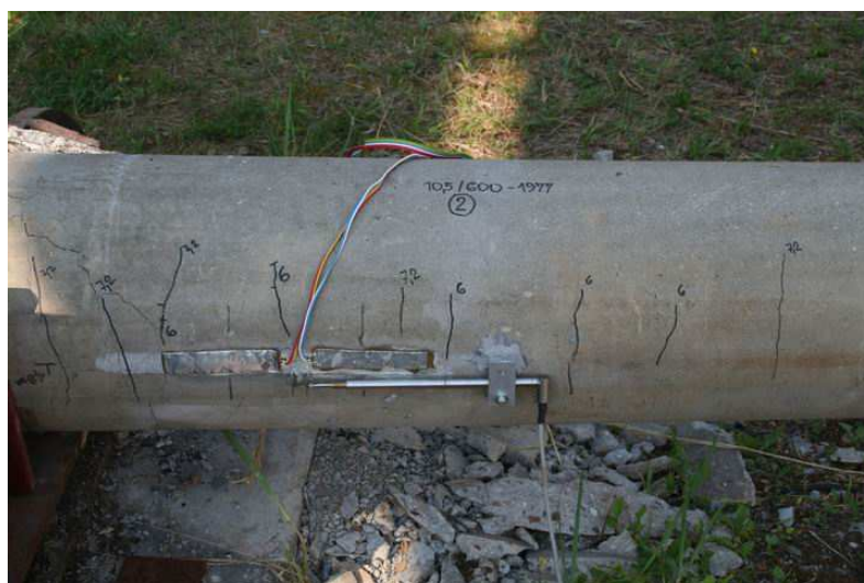
Obr. 2.: Měřící zařízení deformace v tažené zóně (tenzometry T1 a T2, měření dilatace)
