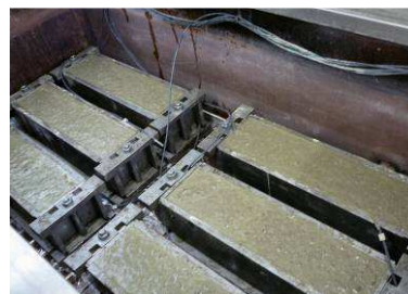
Obr. 5.: Uložení 1. a 2. sady zkušebních těles do chladných podmínek ihned po betonáži (teplota prostředí +10\text{ °C} ).
