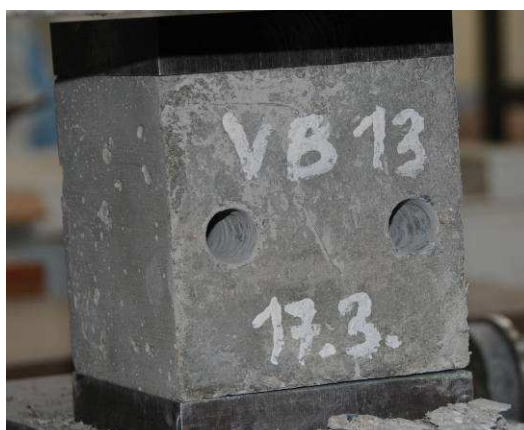
Obr. 2.: Vývrtý ve zkušební krychli (150x150x150 mm) vedle sebe
