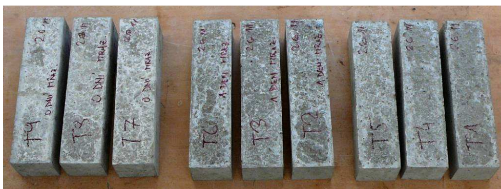
Obr. 7.: Všechna hranolová tělesa před odzkoušením; vlevo jsou 3 referenční hranoly třetí sady, uprostřed 3 hranoly druhé sady (uloženy v chladných podmínkách 1 den), vpravo tělesa uložená při +10 °C 7 dní (první sady).
