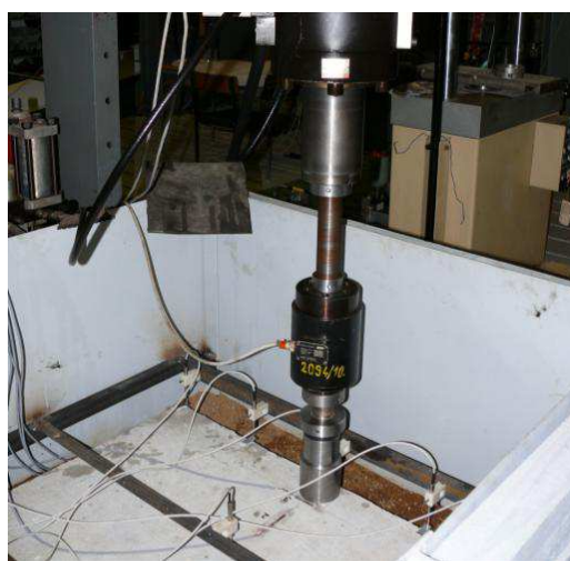
Obr. 1.: Zatěžování CB desky ve zkušebním boxu.
