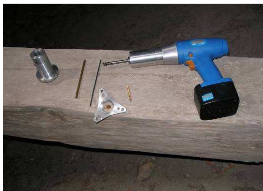
Obr. 11.: Kompletní vybavení pro odběr radiálního vývrtu
