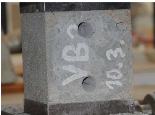
Obr. 3.: Vývrtý ve zkušební krychli (150x150x150 mm) nad sebou
