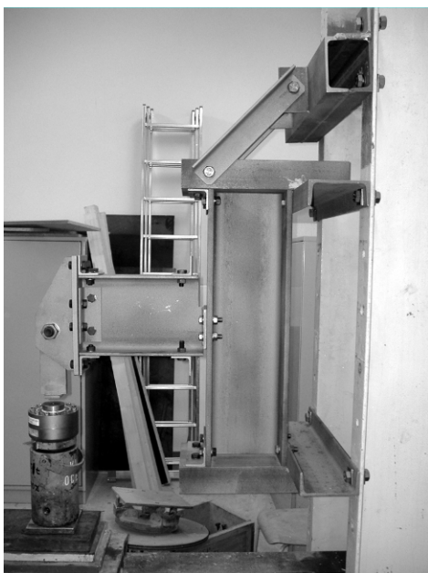
Obr. 2.: Uspořádání zkoušky pro příčné zatížení nosníku
