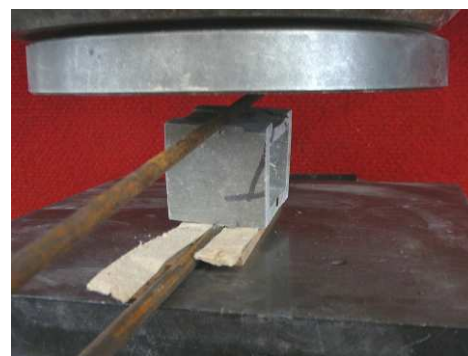
Obr. 4.: Způsob porušení zkušebního tělesa s uzavřeným tenkostěnným čtvercovým průřezem v tahu.
