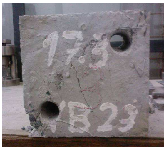
Obr. 4.: Diagonální vývrty ve zkušební krychli (150x150x150 mm)
