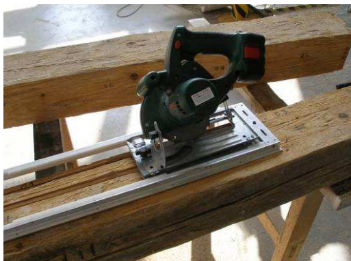
Obr. 13.: Okružní pila s pojezdem upravená pro odběr tahových mikrovzorků
