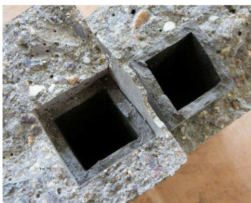
Obr. 12.: Způsob porušení hranolových těles s vloženou kompozitní trubicí prokázal nesoudržnost obou materiálů
