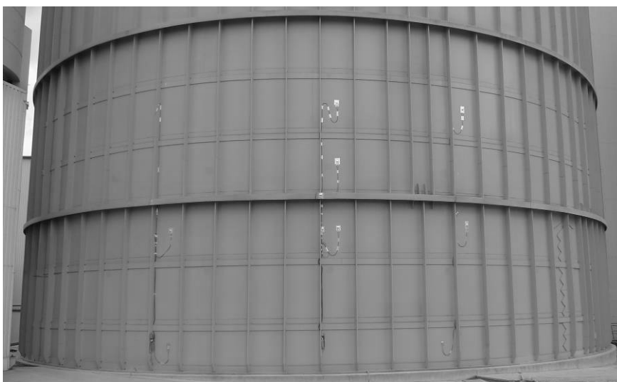
Obr. 13 Rozmiestnenie tenzometrov na plášti slinkového sila
