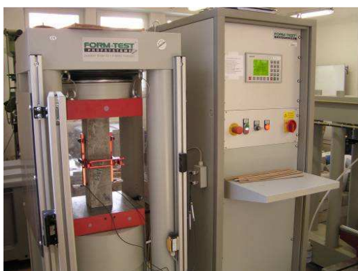
Obr. 5.: Stanovení statického modulu pružnosti v tlaku v lisu FORM+TEST.
