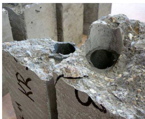
Obr. 12.: Způsob porušení hranolových těles s vloženou kompozitní trubicí prokázal nesoudržnost obou materiálů
