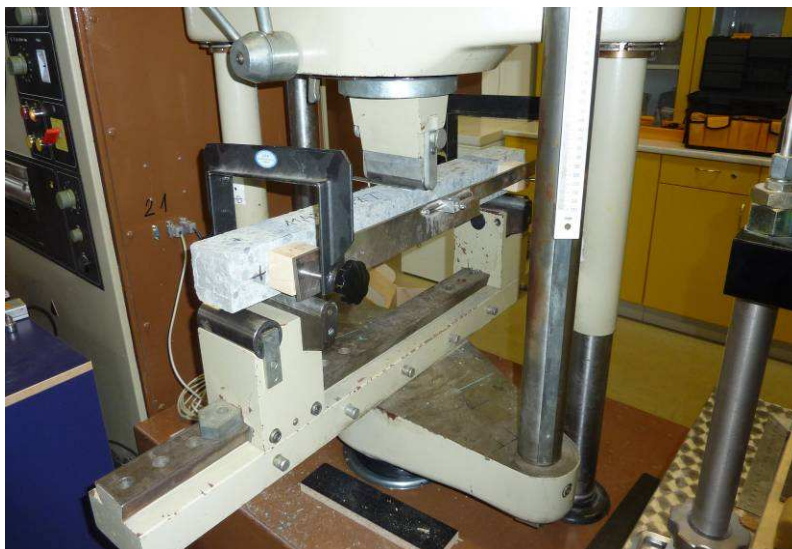
Obr. 1.: Zkouška ohybem vzorku s třibodovým zatížením (prostý nosník zatížený uprostřed)
