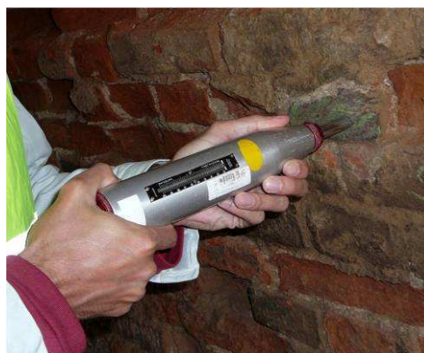
Obr. 5.: Detail zkoušky Schmidtem LB na vybrané cihle
