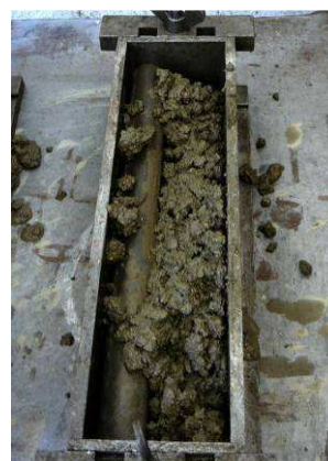
Obr. 4.: Doplnění formy betonem.
